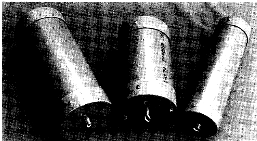
Fig.4. Drie door PA0SE geconstrueerde baluns voor de comudipool. Links type A, gemaakt met RG-62 coax en met een massa van 1,36 kg. In het midden type B, gemaakt met RG-58 coax en een massa van 0,96 kg. Rechts type C, gemaakt met RG-62 coax en met een massa van 0,9 kg. Type C kan het meest worden aanbevolen. (Foto: PA0SE.)
